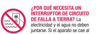
**¿POR QUÉ NECESITA UN INTERRUPTOR DE CIRCUITO DE FALLA A TIERRA?** La electricidad y el agua no deben juntarse. Si el aparato se cae al agua mientras está conectado, una descarga eléctrica puede causar su muerte... **aunque el interruptor esté en la posición de apagado.** Un fusible o un disyuntor/interruptor de circuito regular no le protegerán en esta situación. Un interruptor de circuito de falla a tierra ofrece más protección.
