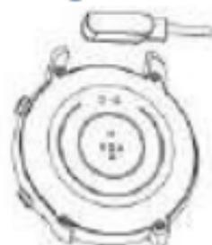
Conecte el cargador magnético suministrado al contacto de carga en la parte posterior del reloj e inserte el otro extremo del cargador en el cargador de
