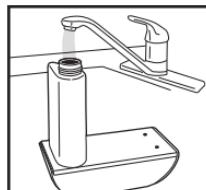
6. Lorsque le transfert de l'eau dans le réservoir d'eau s'arrête, retirer le réservoir d'eau et le remplir de nouveau en suivant les étapes 2 à 5 pour remplir le réservoir d'eau et la cuve.
