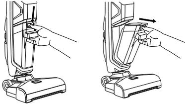
Extraiga el depósito de agua sucia después de su uso. Pulse el botón de extracción para retirar el depósito de agua sucia.
