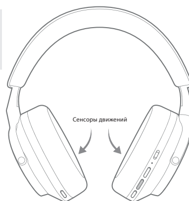
Diagram 3 Расположение сенсоров приближения
