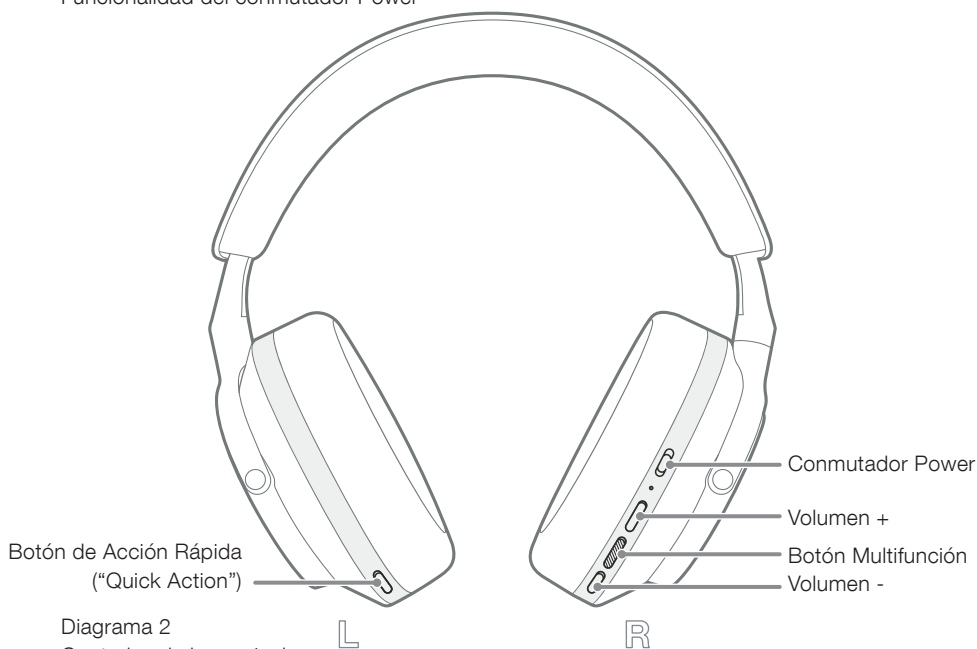
Diagrama 1 Funcionalidad del conmutador Power
